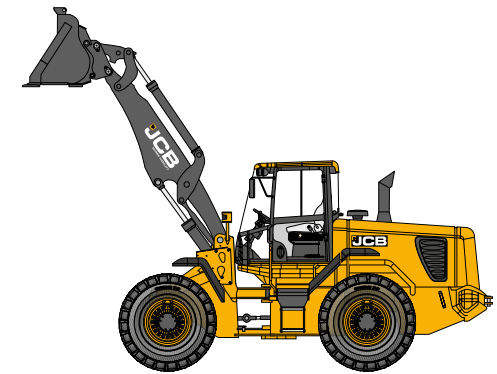
456HT, стрела со сверхвысоким подъемом
