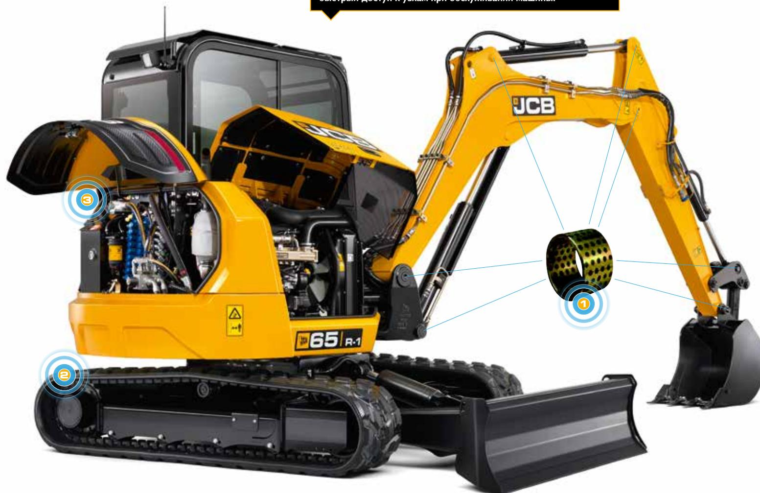
Подъем экскаватора 65R-1 упрощается благодаря наличию защищенных такелажных точек на бульдозерном отвале.
