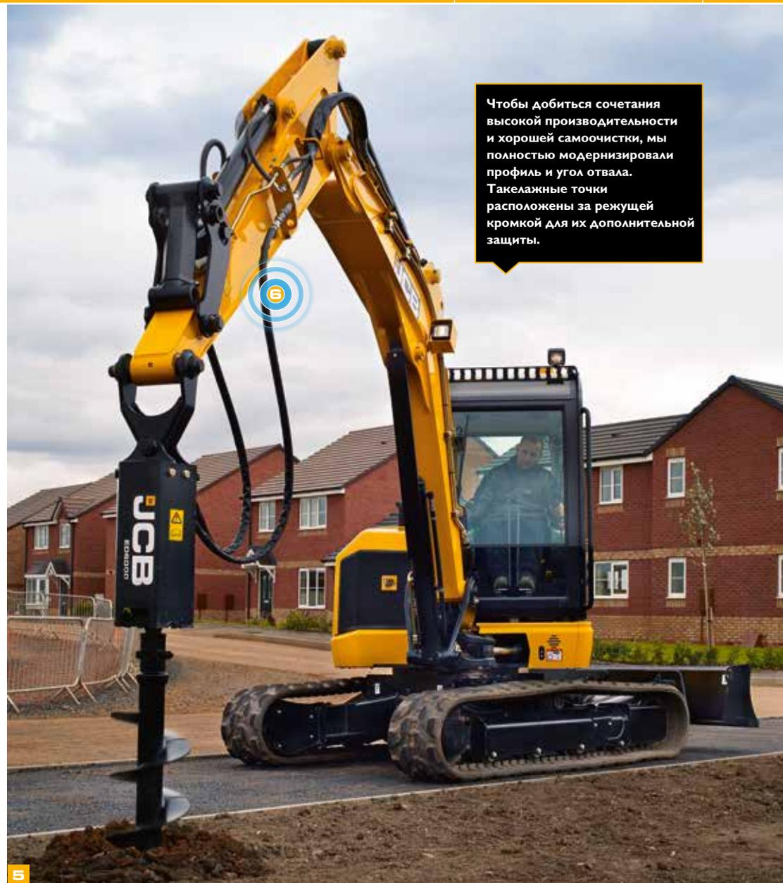
Чтобы добиться сочетания высокой производительности и хорошей самоочистки, мы полностью модернизировали профиль и угол отвала. Такелажные точки расположены за режущей кромкой для их дополнительной защиты.
