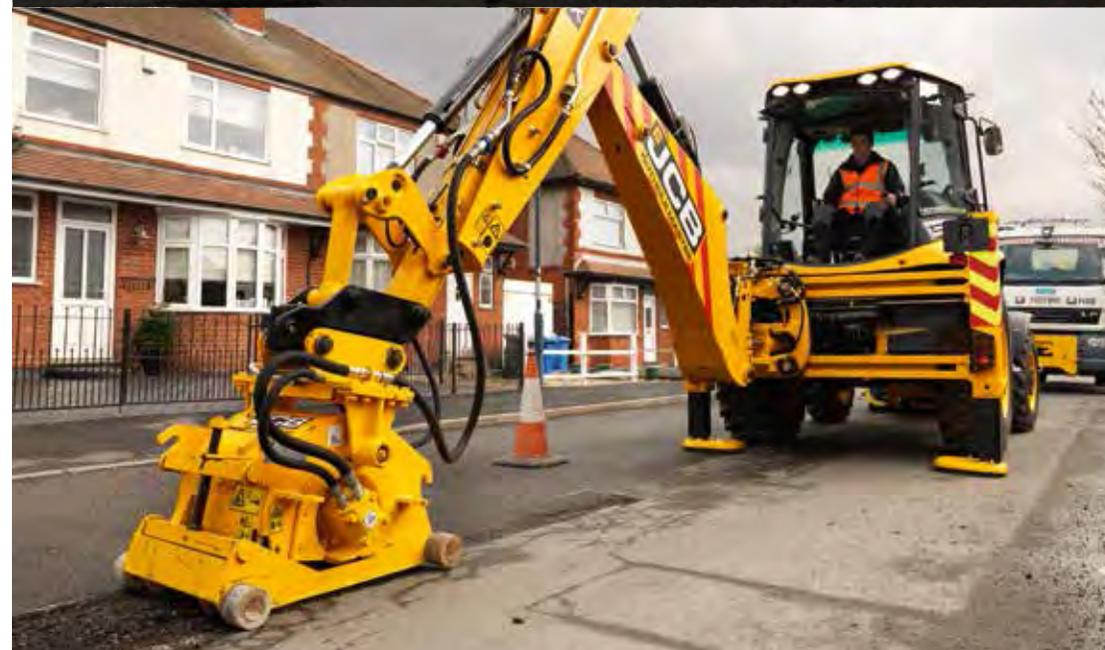
2. ПРОФИЛИРОВАНИЕ | Точное профилирование на глубину до 115 мм.
