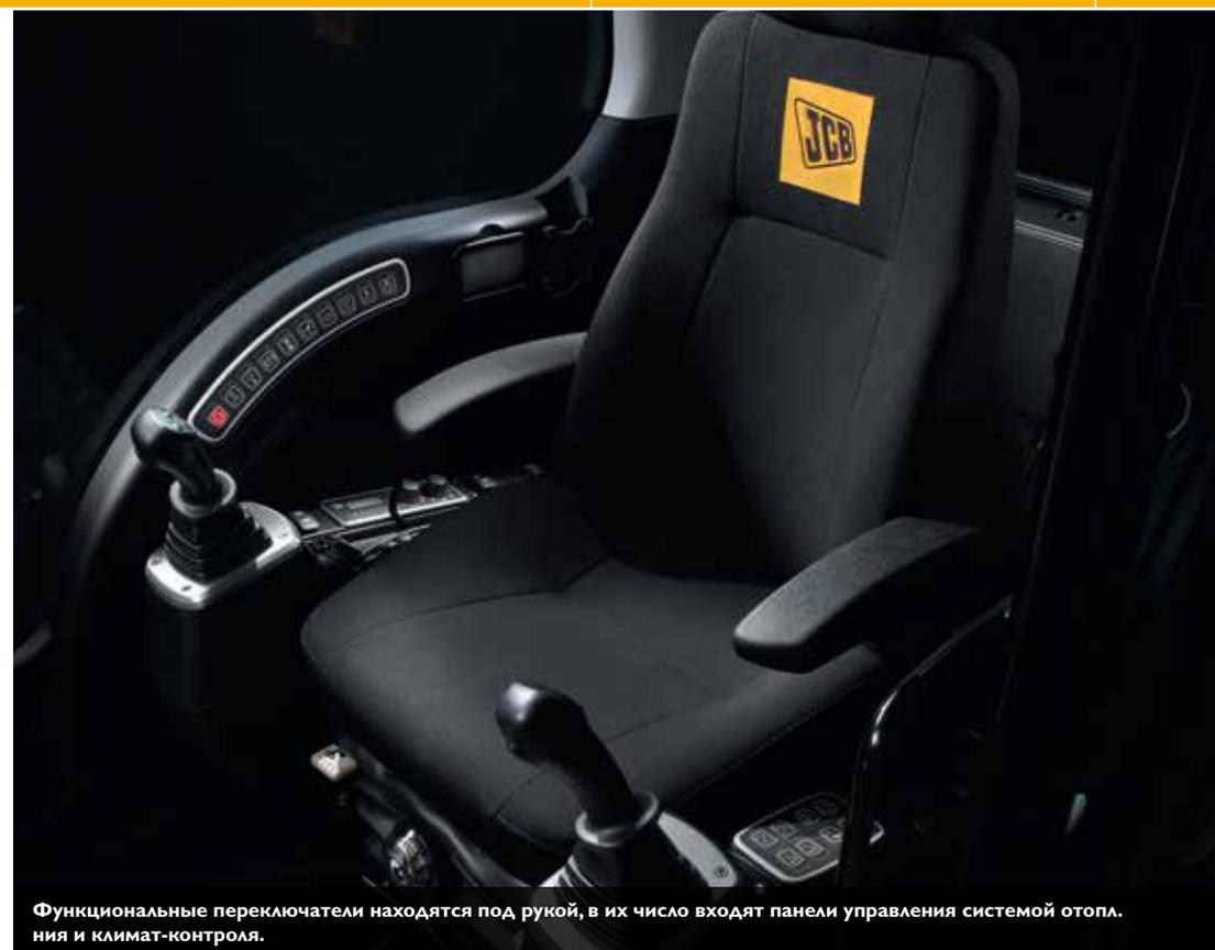
Функциональные переключатели находятся под рукой, в их число входят панели управления системой отопления и климат-контроля.
