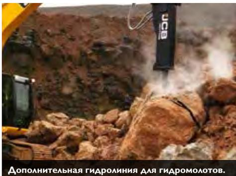
Дополнительная гидролиния для гидромолотов.
