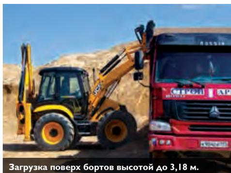
Загрузка поверх бортов высотой до 3,18 м.
