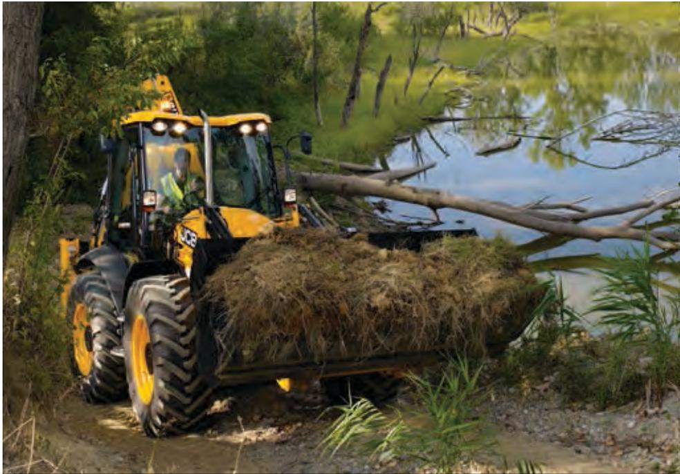
Возможность установить ковш емкостью 1,3 м³ и 3 режима рулевого управления обеспечивают исключительно высокую производительность машины на площадке.
