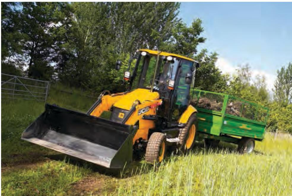
Специально разработанное прочное интегрированное шасси, позволяющее выполнять даже самые тяжелые строительные работы. Поэтому модель JCB Midi CX — это идеальный выбор для арендных компаний, поскольку ее можно легко транспортировать с помощью 7,5-тонного грузового автомобиля.
