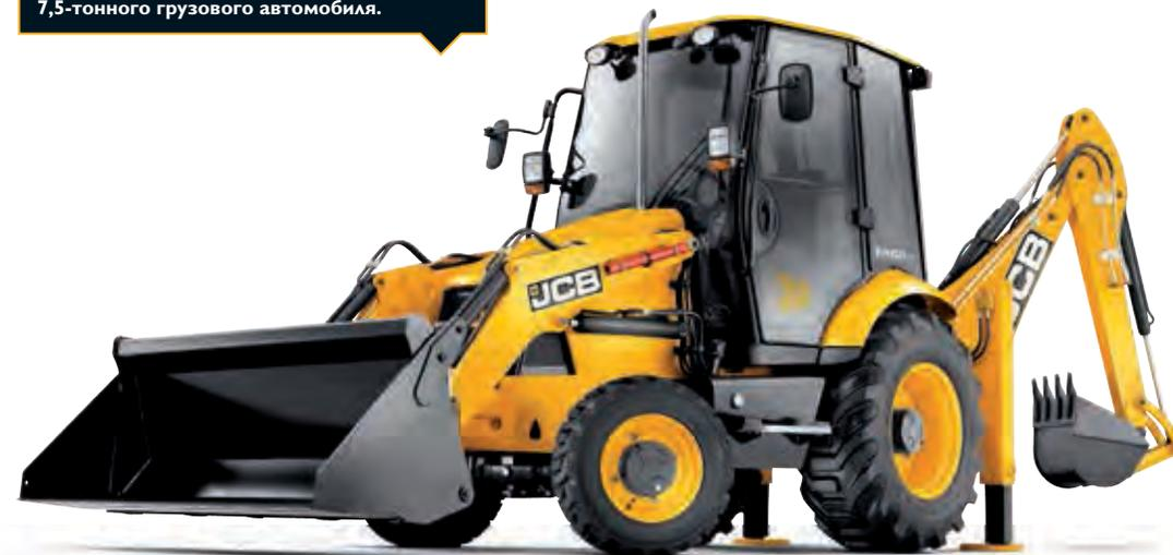
Настоящий экскаватор-погрузчик со съемным экскаваторным оборудованием, что повышает его универсальность и позволяет использовать его с разнообразным навесным оборудованием, предназначенным для тракторов.
