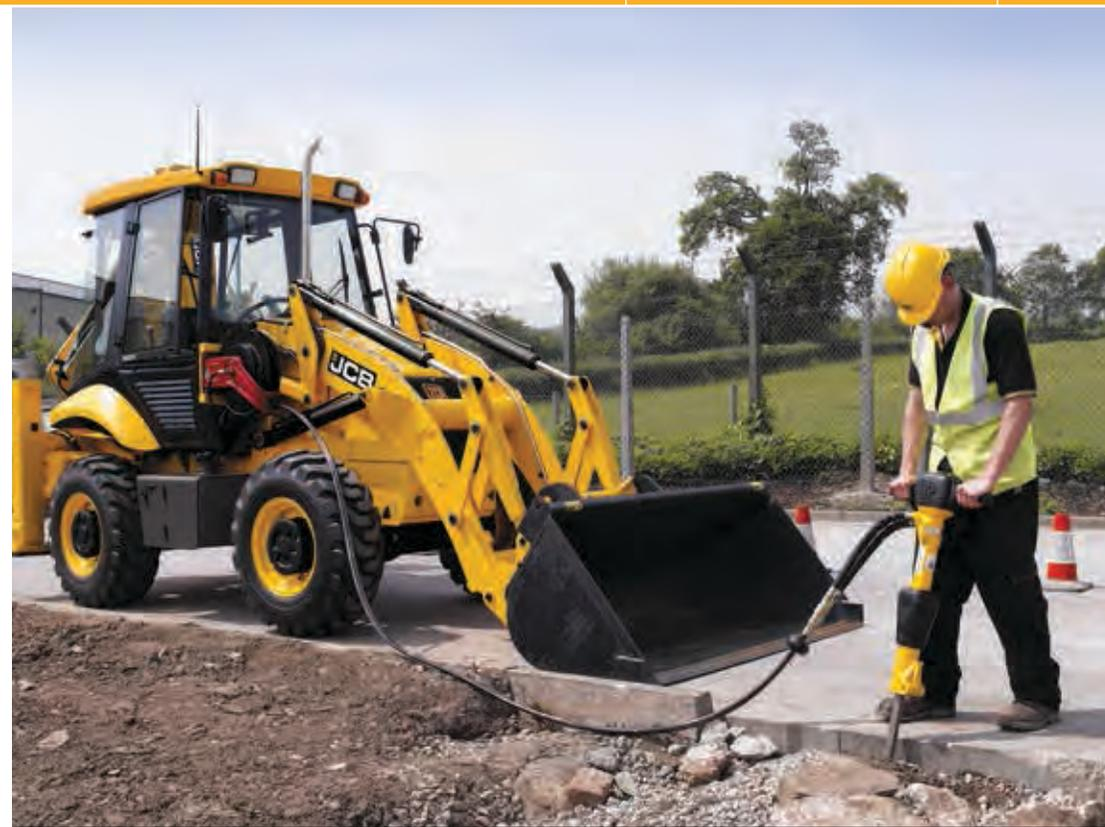
Контур для подключения ручного инструмента превращает машину 2CX в мобильный источник энергии.
