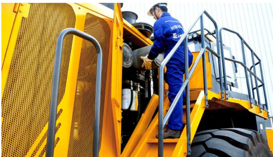
Время технического обслуживания сокращается, а доступ к компонентам облегчается благодаря прочным поручням, устанавливаемым в качестве стандартного оборудования. Они повышают безопасность и упрощают доступ к верхней части конструкции.
