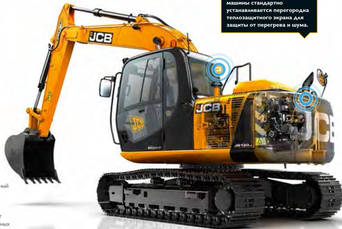
Между насосами и двигателем машины стандартно устанавливается перегородка теплозащитного экрана для защиты от перегрева и шума.
