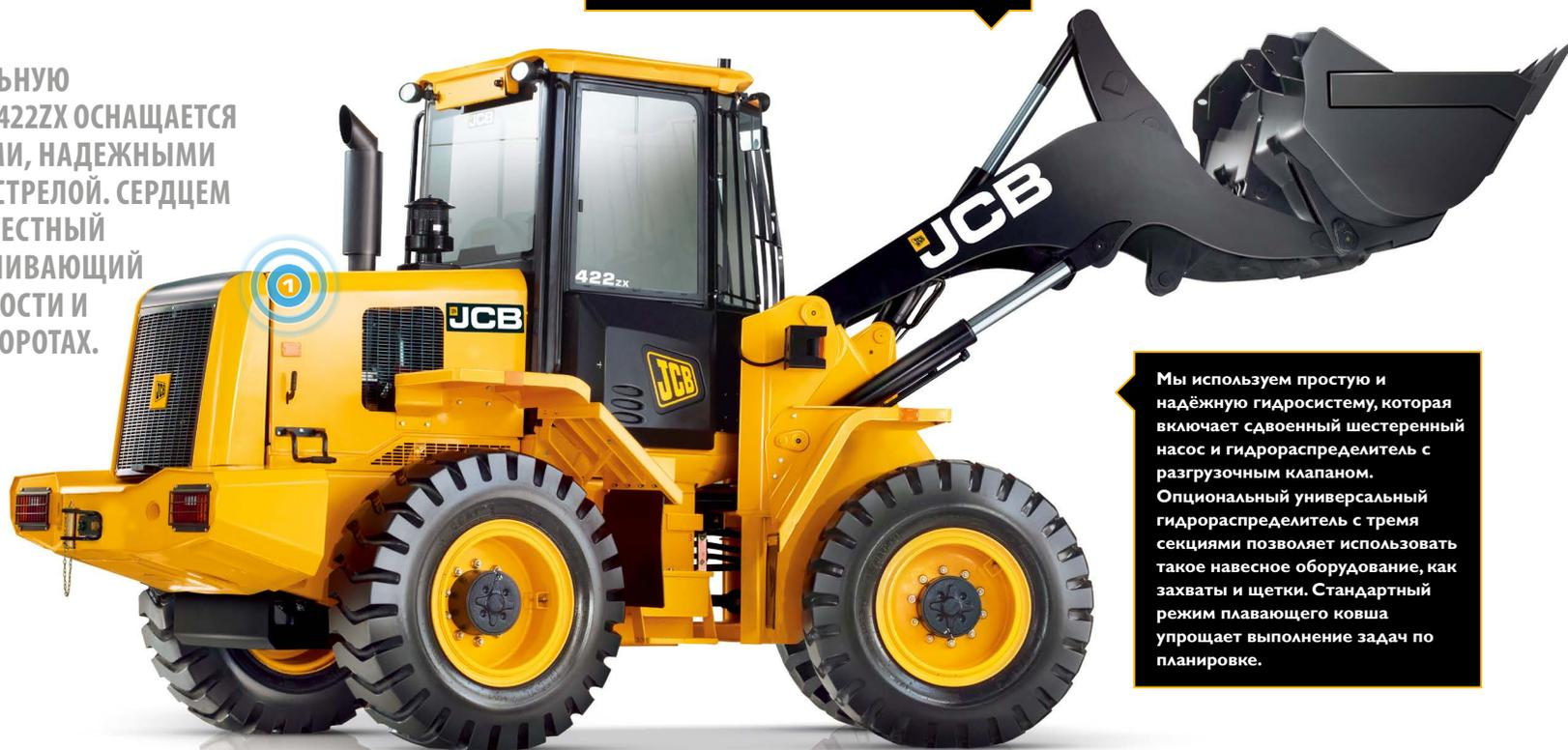
Мы используем простую и надёжную гидросистему, которая включает двоянный шестеренный насос и гидрораспределитель с разгрузочным клапаном. Опциональный универсальный гидрораспределитель с тремя секциями позволяет использовать такое навесное оборудование, как захваты и щетки. Стандартный режим плавающего ковша упрощает выполнение задач по планировке.
