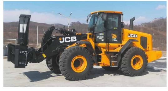
ря чему, технический потенциал погрузчика значительно расширился. Специально для работы с дополнительным навесным оборудованием, силами сервисной службы Владивостокского филиала компании Стройкомплект, была произведена доработка гидролинии фронтального погрузчика ЈСВ 455ZX.
